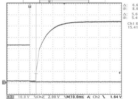
V<sub>IN</sub>=48V I<sub>OUT</sub>=1.0A C<sub>OUT</sub>=1020µF
