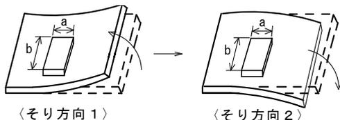
そり方向 1 > そり方向 2 でストレスを受けやすくなりますので、ストレスが加わらないように部品を配置して下さい。
