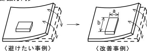
ストレスの作用する方向に対して、横向きに (長さ  $a < b$ ) 部品を配置して下さい。
