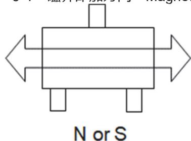
注 1) センサにかかる磁界の向きと、センサの検出磁界方向を合わせて設計下さい。
